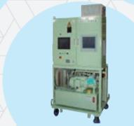
ダイカスト用加圧ピン制御装置
